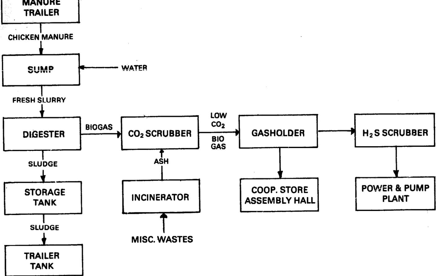
**FIG. 9-9 COOPERATIVE BIOGAS WORKS FLOWSHEET**
