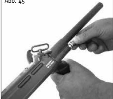
4. Stecken Sie das Sperrventil in die Laufhülse, so dass der Schlitz am Sperrventilkopf mit der Nase der Laufhülse übereinstimmt.
