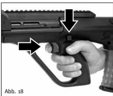
1. Schieben Sie die Sicherung in Feuerstellung.
