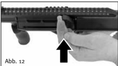
Ziehen Sie mit der linken Hand den Spannschiebergriff zurück und fixieren ihn durch das Schwenken in die Gehäuseausnehmung.
