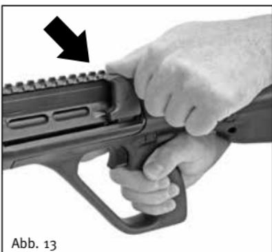
Drehen Sie nun den Spannschiebergriff mit dem Daumen der linken Hand nach außen, sodass der Verschluss durch die Schließfederkraft nach vorne bewegt wird.
