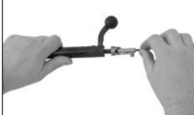
1. Verschluss in die linke Hand nehmen. Mit dem Daumen der rechten Hand die Sperrklappe hineindrücken und gleichzeitig die Verschlusskappe im Uhrzeigersinn (Pfeilrichtung = Drehrichtung) bis zum hörbaren Entriegeln drehen.
