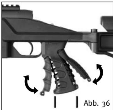
Zum Austausch der vorderen oder hinteren Griffeinlage den Haltestift herausdrücken und die Griff einlage herausheben.
