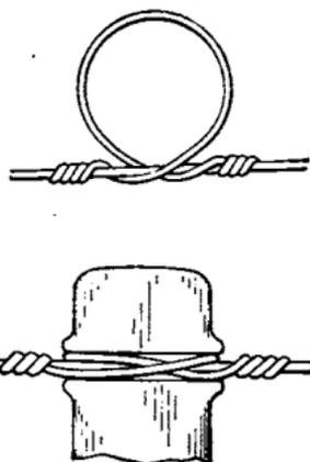
FIG. 38.—Tie for iron wire.
