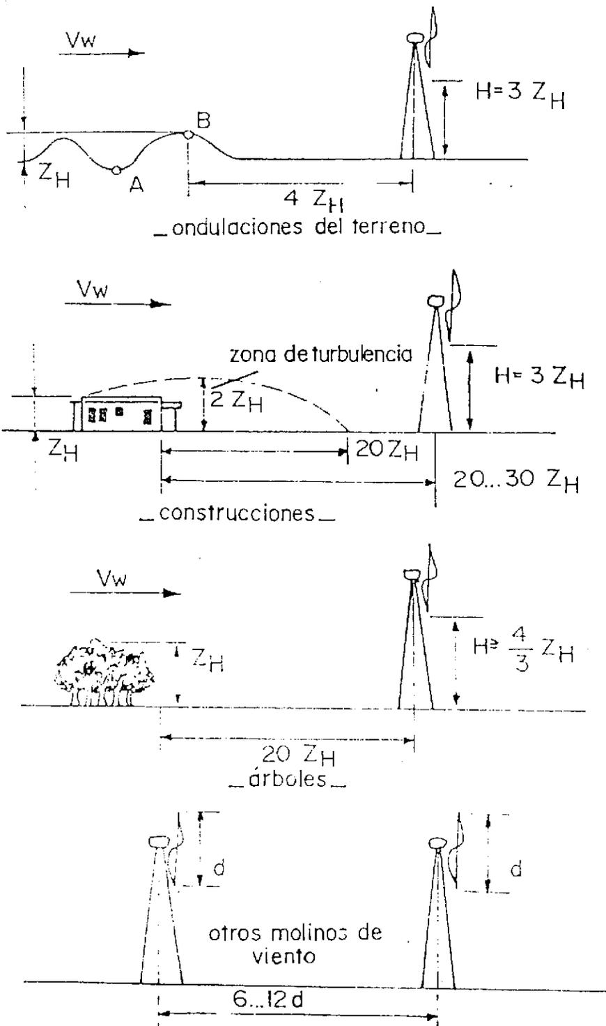
fig.4- Ubicación de las máquinas eólicas según las características del terreno.
