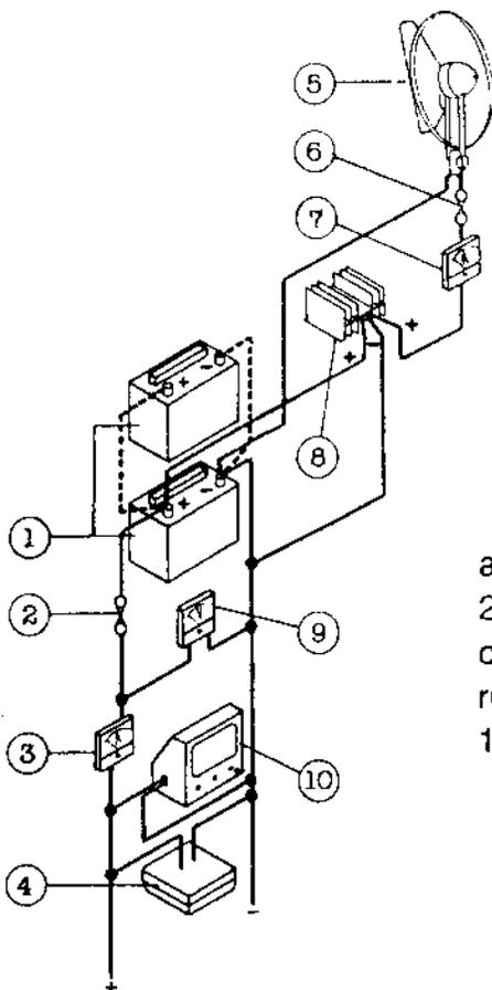
Schaltbeispiel mit Meßpunkten und Meßinstrumenten an einer kleineren Windgeneratoren-Anlage: 1 - Anlagenbatterie; 2 - Sicherung; 3 - Amperemeter (Stromabnahme der Verbraucher); 4 - Leuchte; 5 - Windgenerator (Rutland 500); 6 - Sicherung (5 A); 7 - Lade-Amperemeter; 8 - Laderegler; 9 - Voltmeter; 10 Fernseher (Conrad Electronic)
