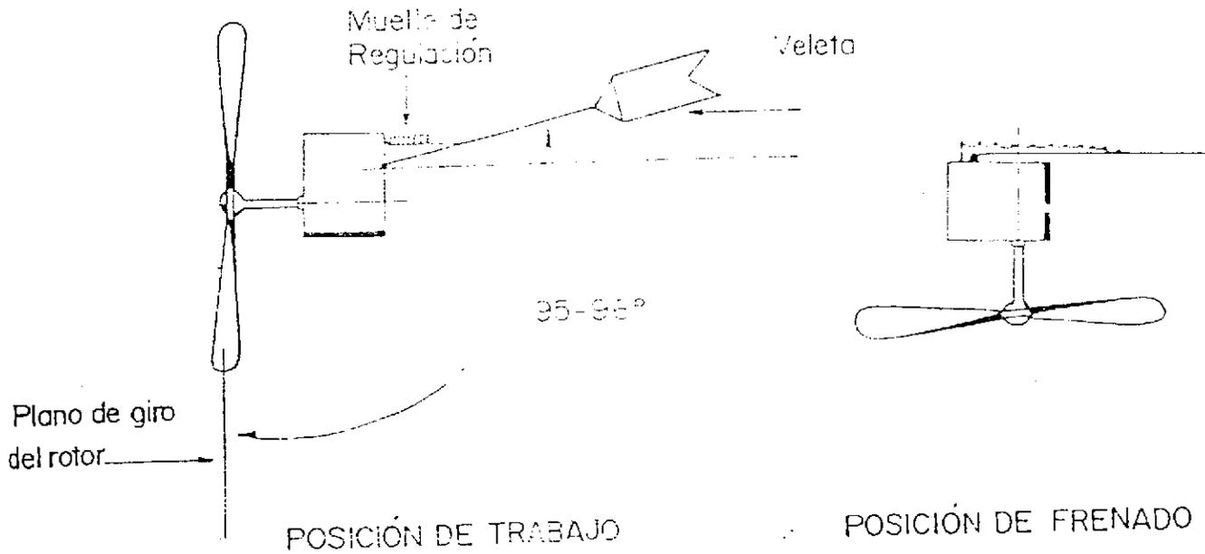
Fig.-8- Sistema de regulación del molino tradicional.
