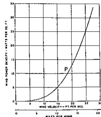
FIG. 2. THEORETICAL POWER DENSITY OF WIND
