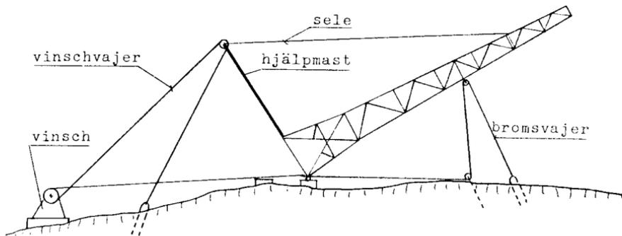
**Fig. 8** Hjälpmastens funktion.
