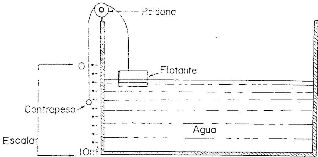
Fig.-7- Marcador del nivel de agua en el tanque
