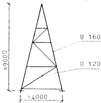
**Fig. 9** Hjälpmastens geometri.
